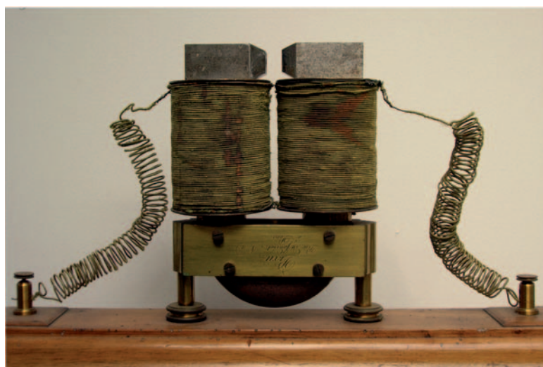
Fig. 4. – L'apparato di Bancalari, custodito presso il Museo del Dipartimento di Fisica dell'Università di Genova. Si può osservare, capovolta, la firma del costruttore (originariamente si trovava, dritta, nella parte superiore della macchina magneto-elettrica di Pixii).
