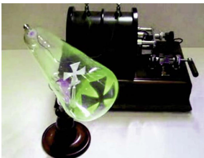
Fig.1: Tubo di Crookes con anodo a forma di croce di Malta. Sullo sfondo il rocchetto di Ruhmkorff che lo alimenta. (Immagine tratta da Wikipedia, alla voce "Crookes tube")
